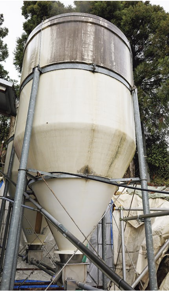
■エサを貯蔵するタンク
